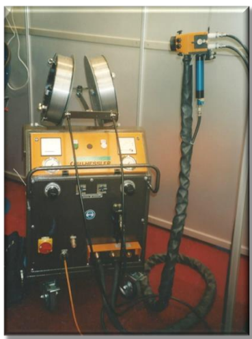
300A LD/U-2 Push – per tutti i fili metallici
