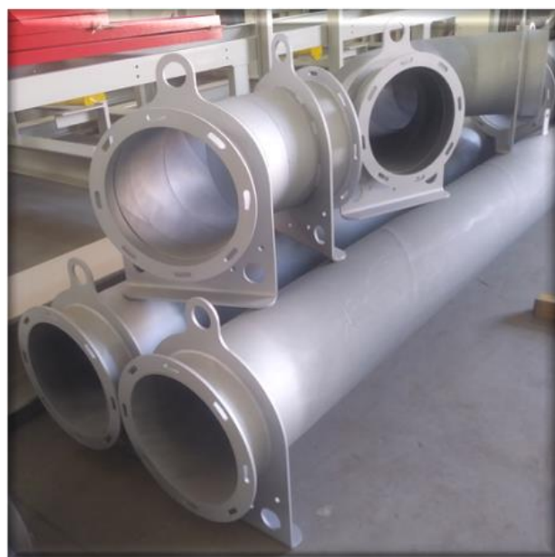
Tubazioni dopo la spruzzatura di Al
