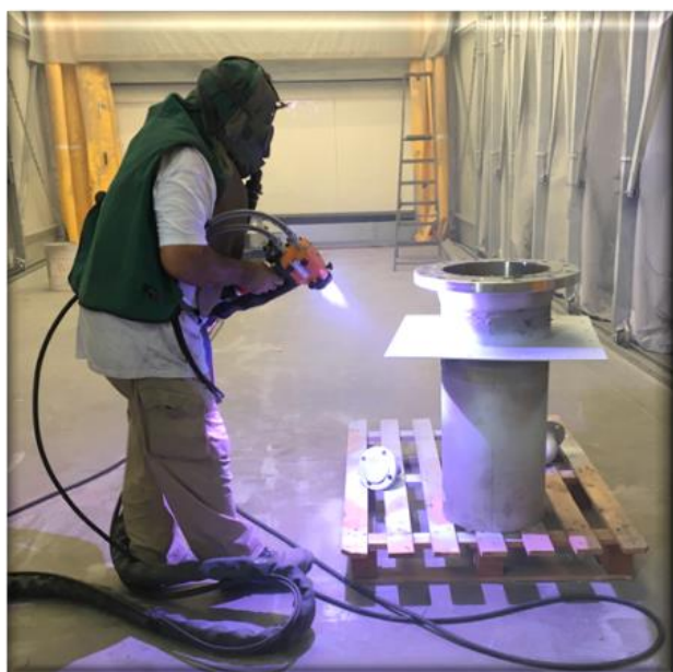
Spruzzatura Alluminio su tubazione
